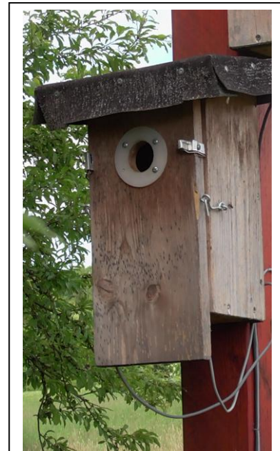
Bild 3.4.1a: Nistkasten NK_D4a mit Lichtschranken und 37 mm Einflugloch
