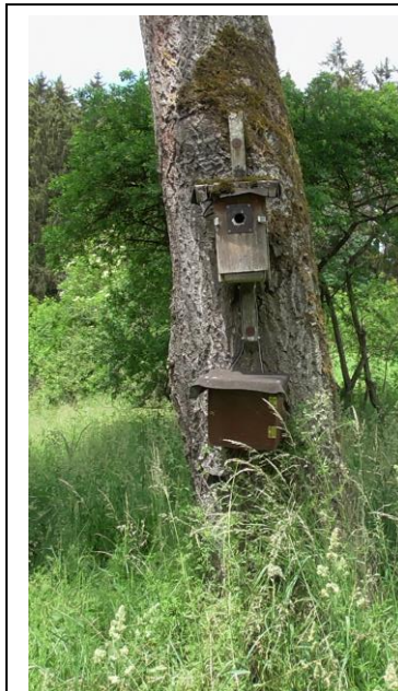
Bild 3.1a: Nistkasten NK_D1 am Baum mit Gehäuse für die Elektronik und dem Akku.
