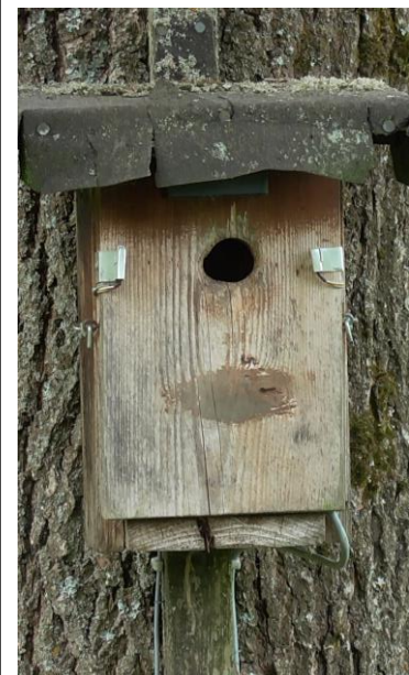
Bild 3.6b: Nistkasten NK_D6 mit den Lichtschranken mit 34x30 mm 2 (B, H) Einflugloch
