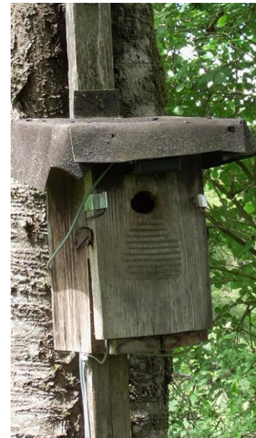
Bild 3.3b: Nistkasten NK_D3 mit äußeren Lichtschranken und 37x31 mm 2 (B, H) Einflugloch
