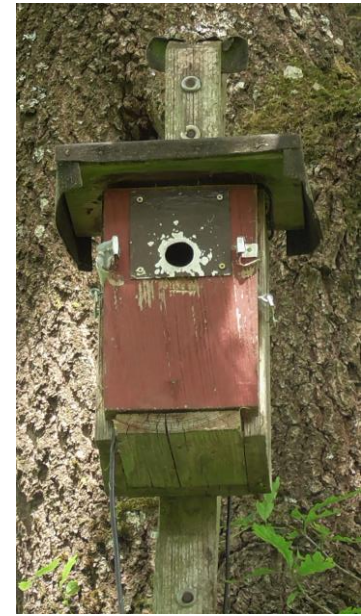
Bild 3.2b: Nistkasten NK_D2 mit den äußeren Lichtschranken und 32 mm Einflugloch.
