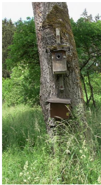
Bild 3.1a: Nistkasten NK_D1 am Baum mit Gehäuse für die Elektronik und dem Akku.
