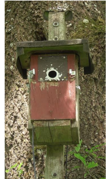
Bild 3.2b: Nistkasten NK_D2 mit den äußeren Lichtschranken und 32 mm Einflogloch.
