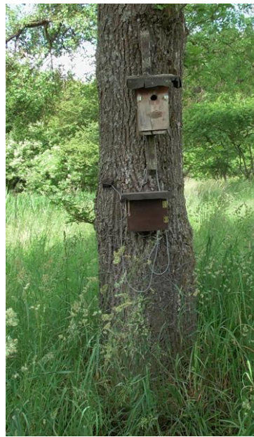
Bild 3.6a: alter Nistkasten NK_D6 am Baum mit Gehäuse für die Elektronik und dem Akku
