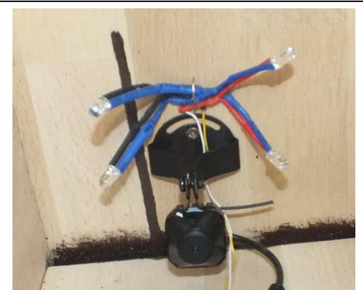
Funkkamera innen mit LED-Beleuchtung
